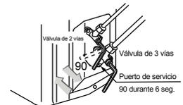
5. ¿No hay fuga de gas? En caso de fuga de gas, ajuste las piezas de la conexión de la tubería. Si la fuga se detiene, continúe con el paso 6. Si no detiene la fuga de gas, descargue todo el refrigerante del puerto de servicio. Después del trabajo de abocinado nuevamente y la evacuación, llene el refrigerante prescrito desde el cilindro de gas.
