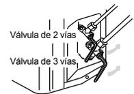
7. Para evitar la fuga de gas, gire la tapa de los puertos de servicio, la tapa de la varilla de la válvula para las válvulas de 2 y 3 vías un poco más que el punto en el que el par de torque aumenta repentinamente.
